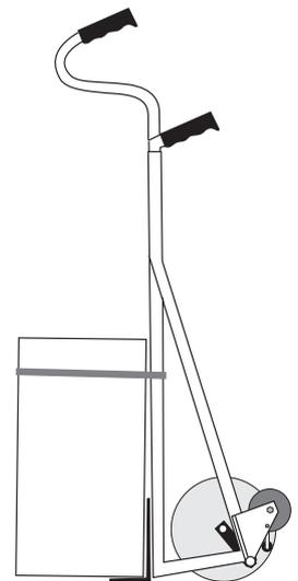
Die Last wird nunmehr dadurch aufgenommen, indem man mit einem Fuß gegen die Kunststoffplatte an der Rückseite des Antriebsgehäuses drückt (der andere Fuß muß festen Bodenkontakt haben), an den Griffen zieht und den **CargoMaster** mitsamt der Last zu sich her kippt.
