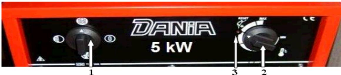
Den Thermostatdrehknopf (2) auf die gewünschte Temperatur einstellen. Ist die Raumtemperatur niedriger als die Thermostat-Temperatur eingestellt, nimmt das Gerät seine Funktion durch Erhitzen auf. Nachdem die eingestellte Temperatur erreicht worden ist, schaltet das Gerät die Heizelemente aus. Der Ventilator wird weiter laufen. Nachdem die Temperatur im Raum gesunken ist, nimmt das Gerät Erhitzen durch Einschalten der Heizelemente automatisch auf.
