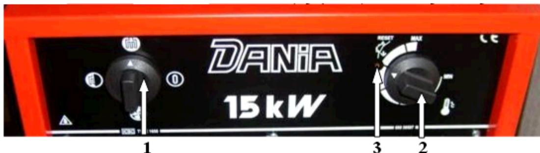
Den Thermostatdrehknopf (2) auf die gewünschte Temperatur einstellen. Ist die Raumtemperatur niedriger als die Thermostat-Temperatur eingestellt, nimmt das Gerät seine Funktion durch Erhitzen auf. Nachdem die eingestellte Temperatur erreicht worden ist, schaltet das Gerät die Heizelemente aus. Der Ventilator wird weiter laufen. Nachdem die Temperatur im Raum gesunken ist, nimmt das Gerät Erhitzen durch Einschalten der Heizelemente automatisch auf.
